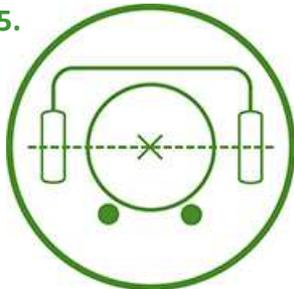
Устройство для предварительного натяжения обмотчика должно быть установлено таким образом, чтобы центр бобины с пленкой располагался на одном уровне с серединой рулона сенажа. Заправка пленки в упаковщик и ее применение должны выполняться в соответствии с указаниями инструкции к упаковочному оборудованию.
