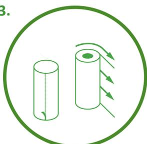
Распаковка бобин должна производиться непосредственно перед использованием. Упаковка открывается с помощью предусмотренных для этого отрывных полосок. Направление размотки указано стрелкой на упаковке.
