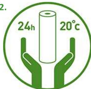
Conservez les bobines dans leur house en plastique et assurez-vous avec soin de manière à ne pas les abîmer. Les bords des bobines doivent être protégés en particulier. Couvrez les bobines qui restent sur l'enrubanneuse pour les protéger de l'humidité. Les bobines doivent être utilisées dans l'année de leur achat.
