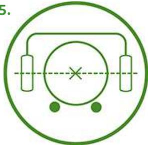
La hauteur de l'unité de pré-étirage doit être ajustée de manière à ce que le centre de la balle et celui de la bobine soient alignés. Enfilez et fixez le film conformément aux instructions d'utilisation de l'enrubanneuse.
