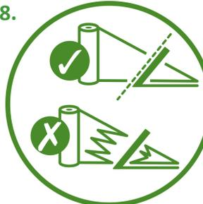
Veillez au maintien de la lame du mécanisme de coupe de l'enrubanneuse afin d'assurer une coupe propre du film après l'enrubannage, ce qui évitera les longs pans de film.
