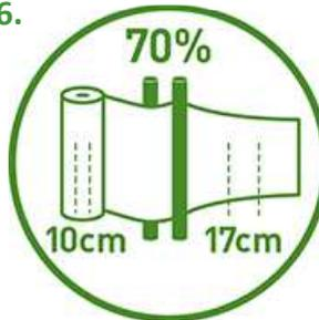
Avec un film de 750 mm, la largeur finale du film mesurée sur l'extrémité plate d'une balle ronde doit être comprise entre 580 mm et 620 mm. Si la largeur du film dépasse largement ces limites, arrêtez l'enrubannage et déterminez la cause. Consultez le fabricant de l'enrubanneuse concernant l'engrenage de l'unité de pré-étirage (PSU).
