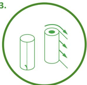
Les bobines ne doivent être retirées de leur emballage de protection que juste avant leur utilisation. Ouvrez la house en utilisant la bande d'ouverture prévue. La flèche sur l'extrémité de la bobine indique la direction de l'enrubannage.
