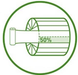
Pārlicinieties, ka pārklāšanās ir vismaz 50%. Pārlicinieties, ka katrs slānis pārklāj vismaz pusi no iepriekšējā slāņa. 500 mm un 750 mm filmām jāpārklājas attiecīgi vismaz par 21 cm un 31 cm. Visām virsmām uzklāj vismaz 4 kārtiņas plēves. Kad MS līmenis pārsniedz 50% vai iesaiņo kvadrātveida rulljus, jābūt vismaz 6 kārtām plēves.
