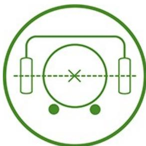
La hauteur de l'unité de pré-étirage doit être ajustée de manière à ce que le centre de la balle et celui de la bobine soient alignés. Enfilez et fixez le film conformément aux instructions d'utilisation de l'enrubanneuse. instructions.
