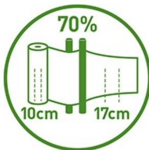
Avec un film de 500 mm, la largeur finale du film mesurée sur l'extrémité plate d'une balle ronde doit être comprise entre 380 mm et 420 mm, et avec un film de 750 mm, elle doit être comprise entre 580 mm et 620 mm. Si la largeur du film dépasse ces limites, arrêtez l'enrubannage et déterminez la cause. Assurez-vous que les rouleaux de l'unité de pré-étirage sont nettoyés régulièrement conformément aux instructions du fabricant de l'enrubanneuse.
