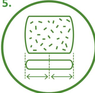
La bobine de Agribale doit être placée au centre de l'unité d'admission, de manière à ce que le centre de la bobine s'aligne avec le milieu de la balle.
